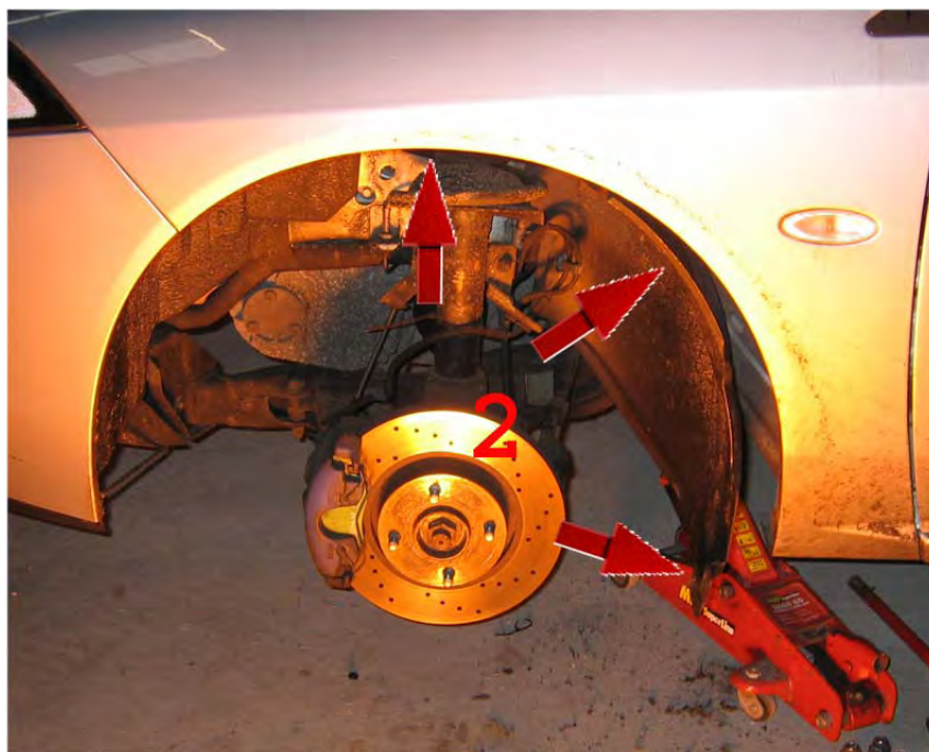
12. Einbauort des Regeleinheit: Hinter dem linken Federbein-Dom.
