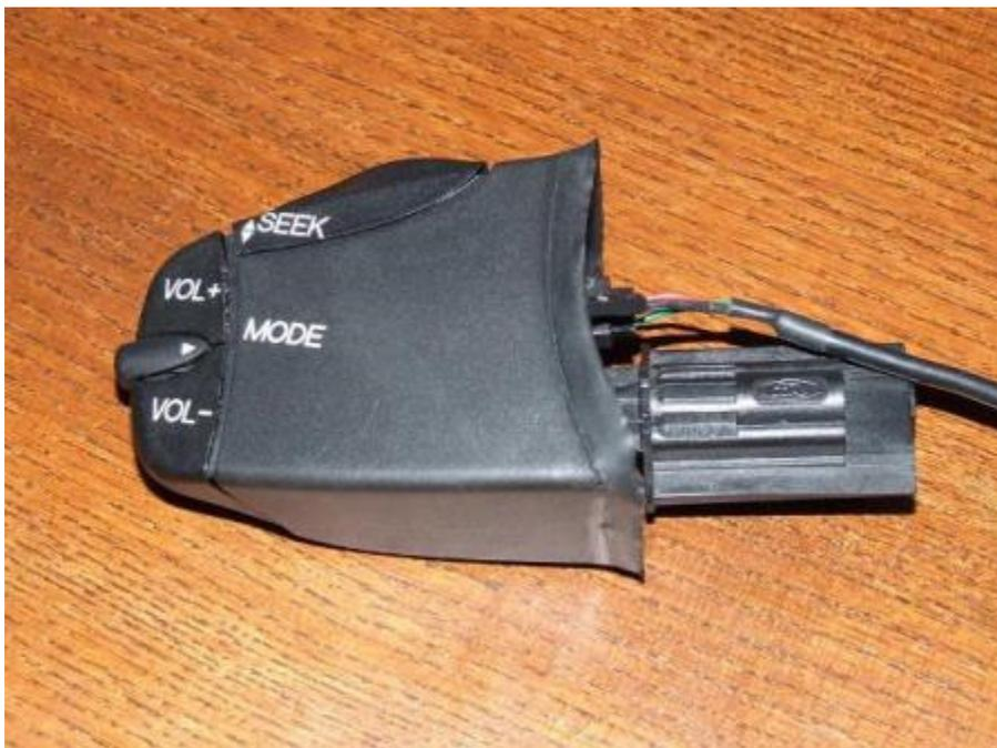
Mondeo bzw Focus FB mit 3 Pin-Anschluss --> Kabel USB-Motherboardkabel
