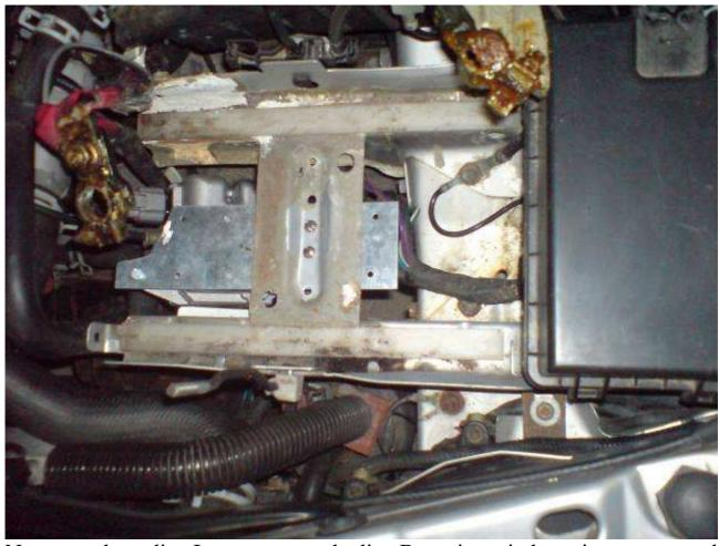
Nun werden die Isomatten und die Batterie wieder eingesetzt und angeschlossen (wie gehabt, erst Plus dann Minus). Dann kommt der Haltebügel wieder drauf und wird verschraubt (nicht zu fest!). Jetzt kommt der Schlauch wieder auf den Ventildeckel. Im Anschluss wird der Plastikdeckel wieder am Motor angebracht - soll ja schön aussehen.
