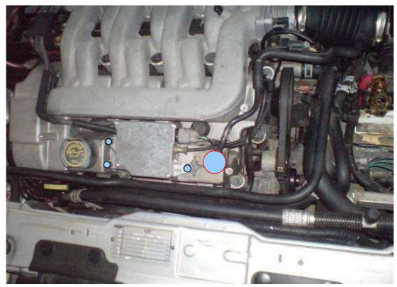
So sollte es jetzt bei euch im Motorraum aussehen. Jetzt wird der Schlauch (roter Kreis) abgezogen. Dann werden die drei Schrauben vom IMRC entfernt.
