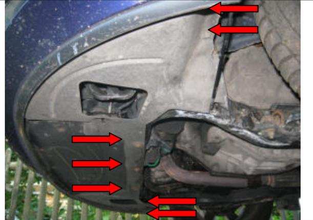
Unterbodenverkleidung entfernen und Halteschiene des alten Kondensators lösen (Habe nur ein Foto vom neuen)
