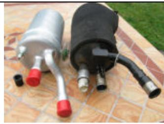
Der **Trockner** ist ein Teil, das man normalerweise regelmäßig wechselt. Er bindet die Feuchtigkeit die sich mit der Zeit in das Kältemittel einschleichen kann und hält sie fest, damit im System kein Schaden entstehen kann. Nach ca. 2 Jahren ist der Filter dann gesättigt. Meine „Trocknerbombe“ war nach 11 Jahren völlig verrostet wie ich feststellte.
