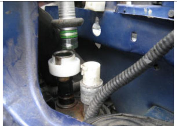
Nach dem Lösen der zweiten Rohrverbindung, kann der Trockner nach unten entnommen werden.
