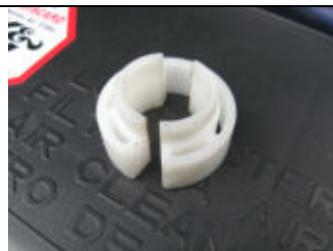
Das **Spring Lock Tool** ist ein Spezialwerkzeug auch genannt „Löseclip“ (Suchbegriff bei Ebay) Mit diesem Kunststoffring bekommt man Klimaleitungen offen, aber auch Kraftstoffleitungen sollen sich damit öffnen lassen. Diese Ringe gibt es in verschiedenen Größen
