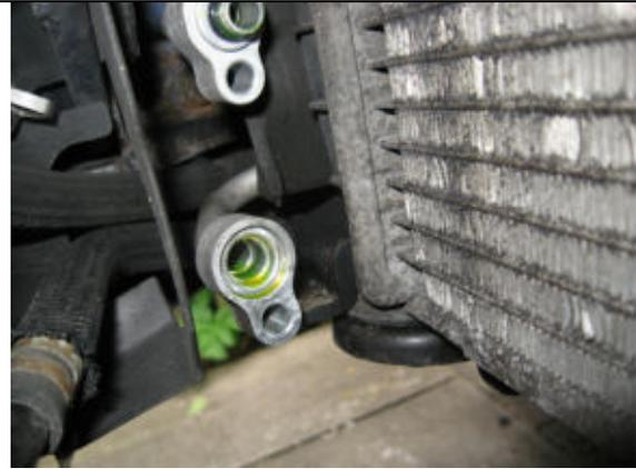
Der Kondensator ist nun frei, kann durch leichten Ruck nach oben aus den Halterungen ausgehakt und dann nach unten weggenommen werden. Anschließend müssen noch die Schraubenbolzen vom alten in den neuen Kondensator gedreht werden.
