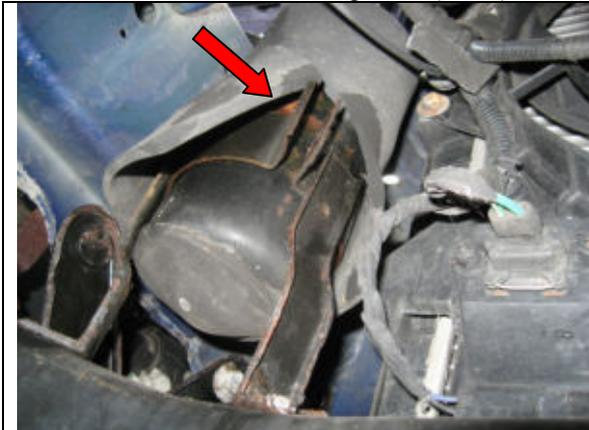
Dann die Schrauben an den Füßen lösen (SW 10)
