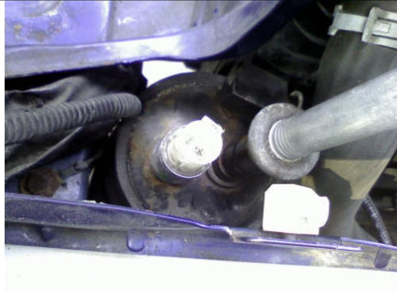
Hier ist noch der alte Trockner zu sehen, bei ausgebaute Starterbatterie und abgezogenem Stecker.
