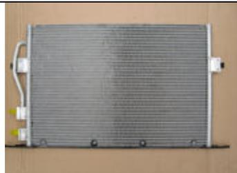
Der **Kondensator** ist eine Art Kühler der vorne vor dem eigentlichen Wasserkühler angebracht ist. Dort gibt das Klimasystem seine Wärme ab, so wie ein Kühlschrank an der Rückwand. Durch die Anordnung vor dem Kühler, bekommt dieser besonders kalte Luft ab, ist aber auch eher Steinschlägen und der Witterung ausgesetzt als alles andere. Dass mein alter Kondensator undicht und weggeammelt war, sah man sogar schon ohne UV Licht.
