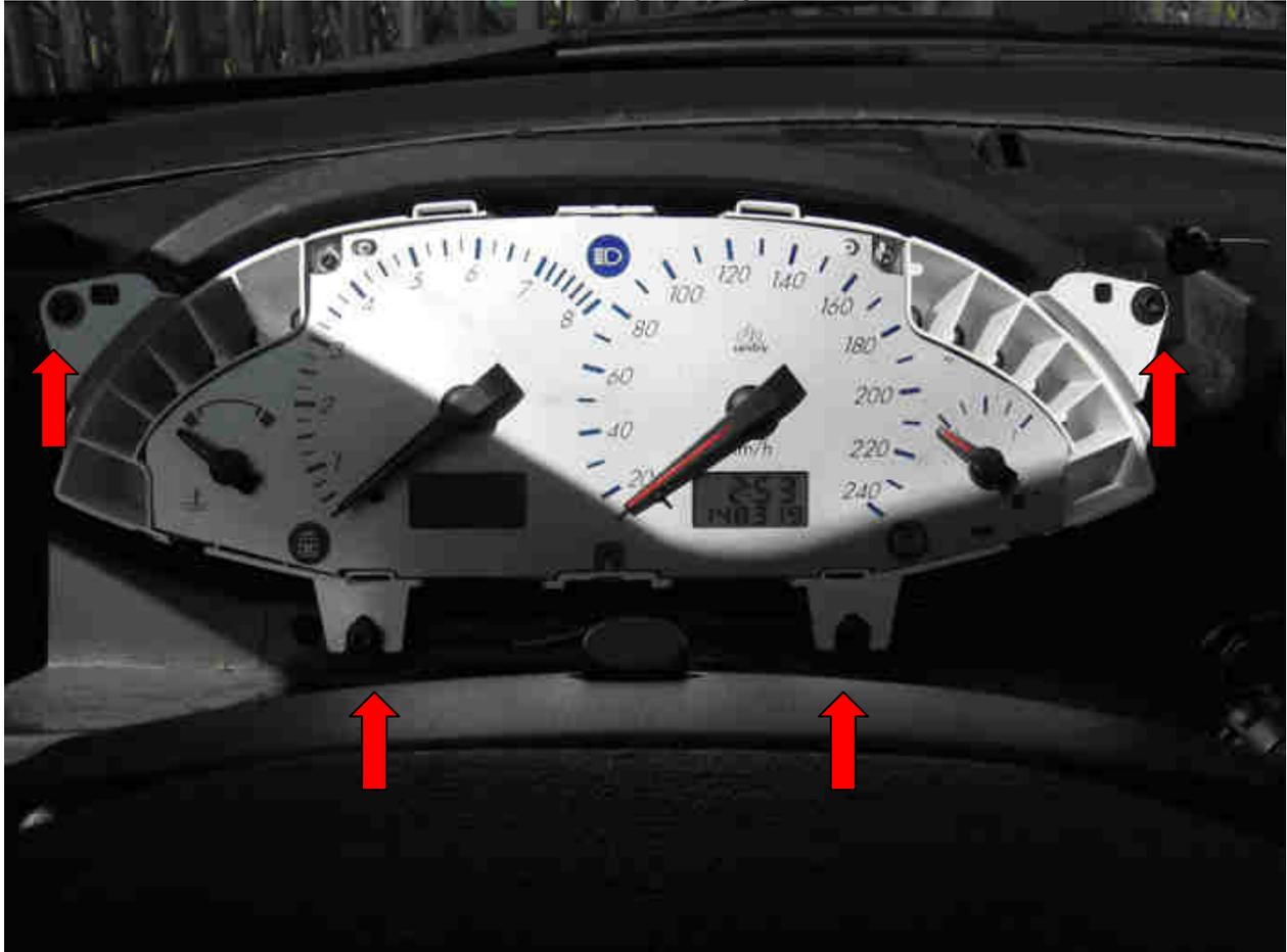
Nach dem Lösen der letzten vier Schrauben, hat man das Kombiinstrument nun in der Hand.
