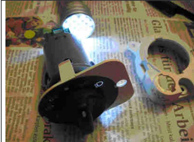
Fertig bearbeiteter Schalter mit 3 LED in Reihe
