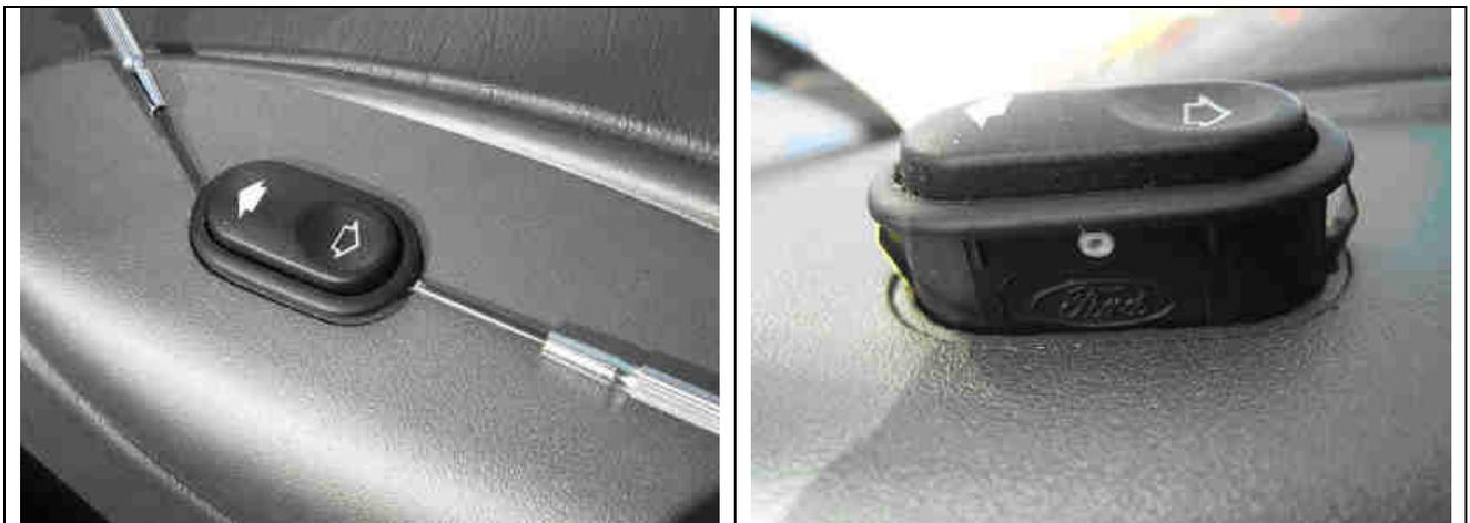
Falls das Herausziehen mit den beiden Uhrmacherschraubendrehern nicht funktioniert, muss die Türverkleidung entfernt werden. Das ist aber ganz leicht. Dazu das Cougar Logo am Türgriff vorsichtig weghebeln und die dahinter liegende Kreuzschraube lösen. Die zwei Schrauben unten in der Türablage müssen ebenfalls gelöst werden. Dann noch die 3 seitlichen kleinen Torxschrauben rechts und links an der Türverkleidung lösen und man kann mit sanfter Gewalt das ganze Teil nach oben abziehen.
