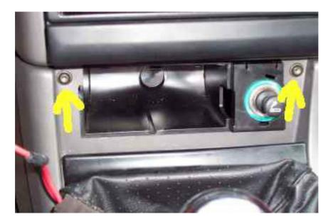
3) Nun müssen 3 Torx-Schrauben aus dem CD-Fach hinter der Handbremse raus
