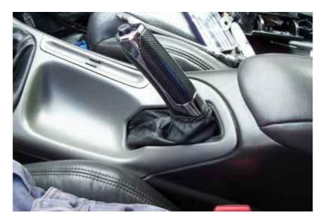
5) Als letztes einfach die Halterung für den Schalthebel aus der Mittelkonsole clipsen.
