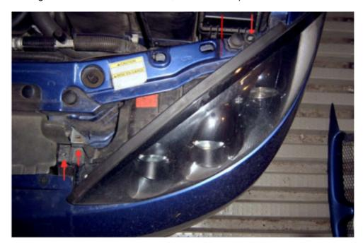
Die vierte Schraube ist etwas versteckt (auf dem vorherigen Bild der gestrichelte Strich – auf dem unteren Bild der Pfeil mit der 4. daneben). Sie fixiert ein auf einer Seite offenes Halteblech (U-Form). Sobald diese Schraube gelöst ist (nur lösen!, da es bei kompletter Entnahme sehr schwierig ist, sie wieder hineinzubekommen), ist der Scheinwerfer nur noch an den Kabeln angeschlossen.
