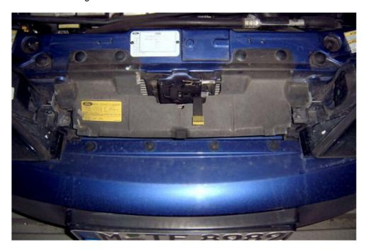
2. Als nächsten müssen die restlichen Schrauben gelöst werden die die Scheinwerfer halten (pro Scheinwerfer insgesamt 4 Schrauben – inkl. der "Grill-Schraube").
