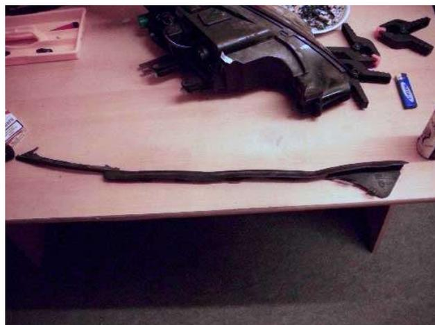
Nun kommt der knifflige Part, das Trennen der Vorder- von der Rückseite. Falls der Scheinwerfer neu abgedichtet werden soll, kann schon mal das offen liegende Klebematerial grob entfernt werden. In der Regel kann aber auch der Originalkleber wiederverwendet werden, dann möglichst nichts entfernen.
