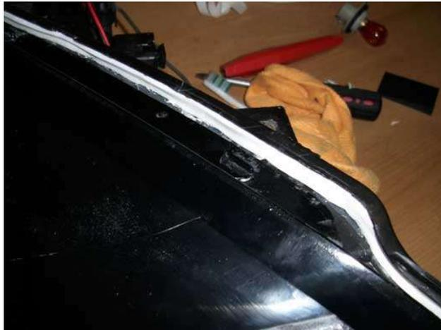
Das Dichtungsband ist nach dem zusammenclipsen kaum noch sichtbar, nur an 1-2 Stellen:
