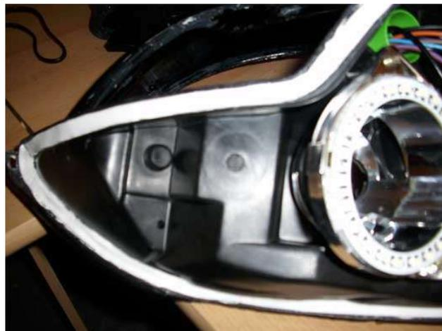
Anschließend wieder zusammenbauen. Nicht die Dichtungslippe vergessen, bevor die Klammern wieder befestigt werden. (So wie ich auf dem Foto^^) Die Klammern lassen sich einfach von Hand mit leichtem Druck wieder aufclipsen.
