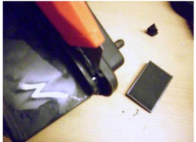
Immer wieder leicht anhebeln, und den sichtbaren Kleber mit dem Cuttermesser durchtrennen. So langsam vorarbeiten, erst an der Unterseite...
