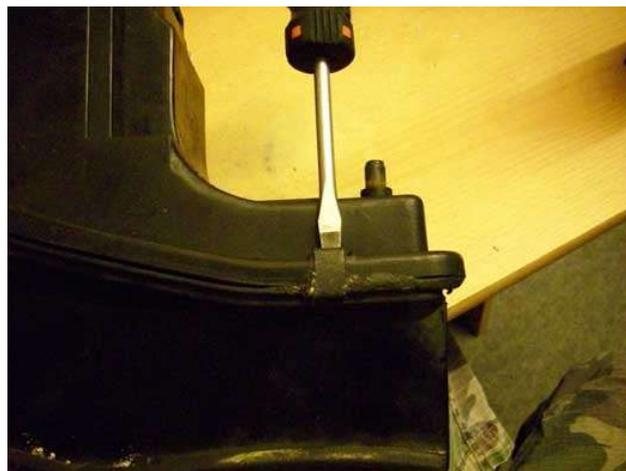
Als nächstes wird die obere Gummilippe entfernt. Hierzu müssen die Plastikklammern nach oben herausgezogen werden. Nur Notfalls wieder den Schrauber verwenden, da die Kunststoffteile sehr brüchig sind. Wahrscheinlich wird der ein oder andere abbrechen, das lässt sich leider kaum verhindern. Aber halb so wild.
