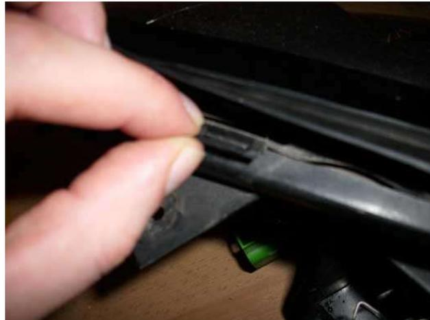
Dann kann die Dichtung leicht abgezogen werden, Vorsicht nur an der Ecke hier muss die Dichtung seitlich herausgezogen werden.
