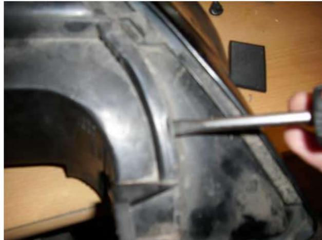
Irgendwann lässt der Kleber nach, und die Teile lassen sich auseinanderziehen. Zum Entfernen des Inlays muss noch eine Schraube gelöst werden.
