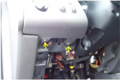
11) Jetzt kann man das Plastikteil mit dem Lichtschalter einfach abziehen. Auch hier ist der obere Teil wieder zusätzlich mit ein paar Clips befestigt. Dann die beiden Schrauben raus.
