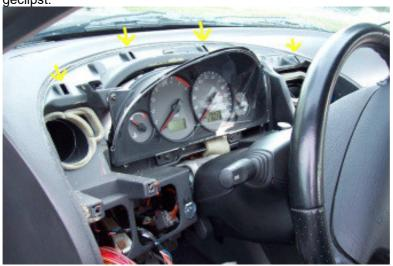
13) Am Tachogehäuse befinden sich nochmal vier Schraube die gelöst werden müssen.
