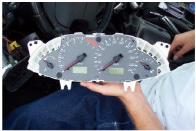
Wenn die Nadeln ab sind kann man die Tachoscheibe abziehen. Die Tachoscheibe ist aufgeklebt, daher Vorsicht beim Abziehen. Eventuell kleben gebliebene Teile kann man dann einfach vom Tachogehäuse abkratzen.
