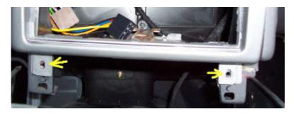
Als nächstes müssen das Thermometer und der Stecker vom Tripcomputer weg. Das Thermometer ist einfach nur in die Halterung geclipst.
