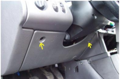
Dafür mit einem kleinen Schlitzschraubendreher die beiden Abdeckungen links und rechts entfernen. Für die beiden Schrauben dahinter braucht man die 7er Nuss. Danach hängt das Plastikteil nur noch an 4 oder 5 Clips. Jetzt das komplette Teil nach unten rausziehen.
