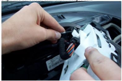
15) Nachdem der Tacho jetzt endlich draußen ist müssen wir die schwarze Abdeckung vorne lösen. Befestigt ist das Ganze mit 5 schwarzen Plastikclips. 3 oben und 2 unten. Beim aufbiegen vorsichtig sein, damit sie nicht abbrechen.
