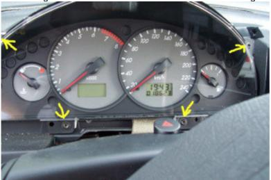
14) Sobald auch die Schrauben weg sind kann man den kompletten Tacho rausnehmen und die beiden Stecker an der Rückseite entfernen. Die Stecker werden durch jeweils einen schwarzen Bügel gehalten. Einfach mit einem kleinen Schraubendreher die Nase des Steckers runterdrücken, so dass sich der Bügel zurück klappen lässt. Beim zurückklappen des Bügel wird der Stecker automatisch rausgedrückt.
