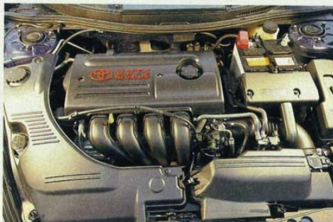
Antrittstark im unteren Drehzahlbereich, aber zäh, wenn er gefordert wird: 1,8-Liter-Motor mit variabler Ventilsteuerung
