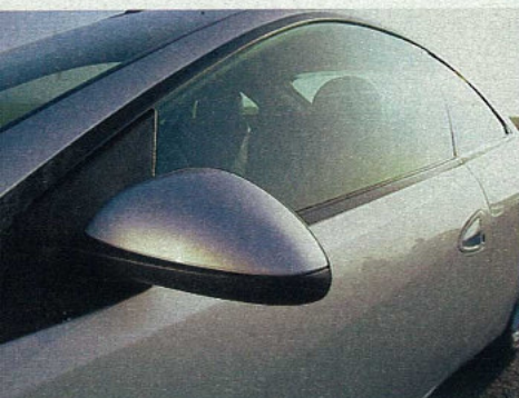
Konvexe Dachlinie mit gerader Fensterlinie
