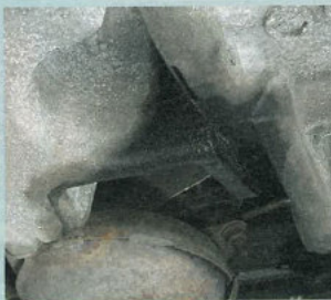
Ausgelaufen: Motor und Getriebe des Cougar sind selten ganz dicht und verlieren ihren Schmierstoff
