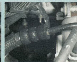
Schwäche des Peugeot 406: Auch beim Coupé kleckern häufig die Motoren und Getriebe
