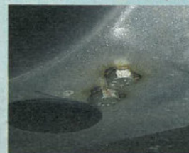
Unschön: Rost gibt es trotz guter Vorsorge immer wieder an Schrauben und Anbauteilen
