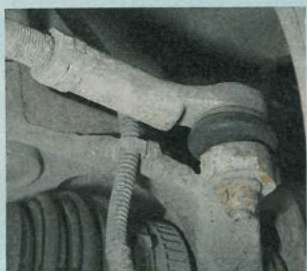
Ausgespielt: Bei den Hauptuntersuchungen fällt die Lenkung häufiger wegen zu viel Spiel durch
