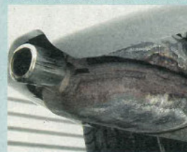
Oben hui, unten pfui: Die Abgasanlagen des Coupés haben ein kurzes Verfallsdatum
