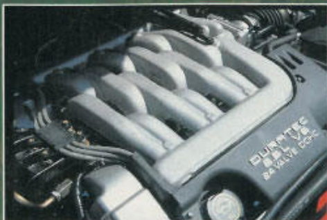
Motor: Der Sechszylinder leistet 170 PS aus 2,5 Liter Hubraum.
