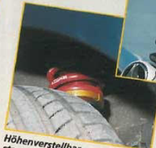
Höhenverstellbar - aus den USA stammt das Eibach-"Ground Control"-Kit mit Gewindeaufsätzen
