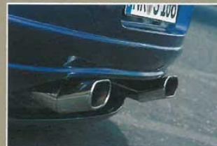
Durch den Heckdiffusor ragt die Doppelrohr-Anlage
