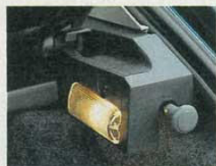
Die umklappbaren Rücksitzlehnen lassen sich nur vom KOFFER-RAUM AUS ENTRIEGELN . Eine Diebstahlsicherung, die für ein Auto mit großer Heckklappe ungewöhnlich ist
