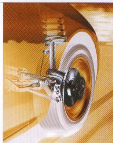
Einzelradaufhängung vorne mit McPherson-Federbein.
