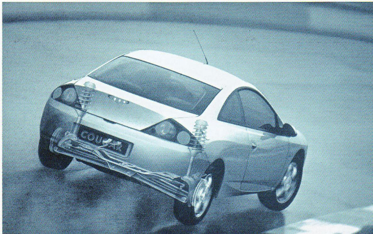
Komfortabel und ausbruchsicher – die Quadralink-Hinterachse.
